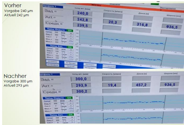
Bild 7: Darstellung der Dickenverteilung vor und nach Änderung der Prozessparameter (Aufgabe: Umstellung von 240 µm auf 300 µm)
